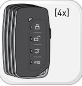
[4x] **AVERTISSEMENT:** Compléter la procédure de programmation du module et la procédure de programmation du tach avant de programmer les télécommandes. Un maximum de quatre [4x] télécommandes par système.
