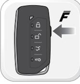
Pour programmer des télécommandes supplémentaires avec le mode second véhicule: Suivre les étape 1 à 4. Appuyer deux fois [2x] sur le bouton "F" puis appuyer une fois [1x] sur le bouton VERROUILLER de la télécommande. Suivre les étapes 6 à 9.
