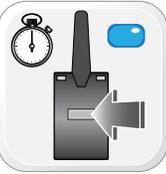
Appuyer et relâcher le bouton de l'antenne, puis appuyer et tenir le bouton de l'antenne. Les DELs de l'antenne émettront une lumière BLEUE.
